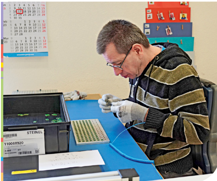
Mitarbeiter Guido arbeitet jeweils sorgfältig und mit Handschuhen: Denn der Arbeitsplatz muss so eingerichtet sein, dass die Platten keine Spannung aufnehmen.
